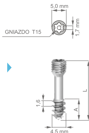
WKREĆ KOMPRESYJNY KANIULOWANY COMPRESSION CANNULATED SCREW
