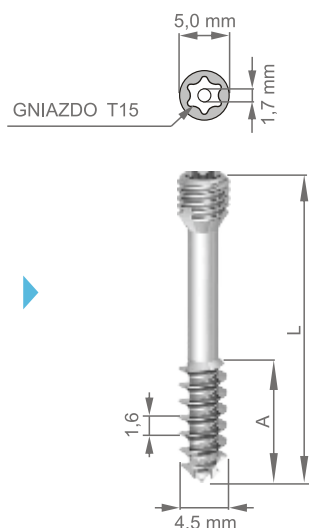
WKREĆ KOMPRESYJNY KANIULOWANY COMPRESSION CANNULATED SCREW
